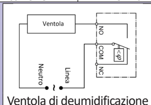
Ventola di deumidificazione
